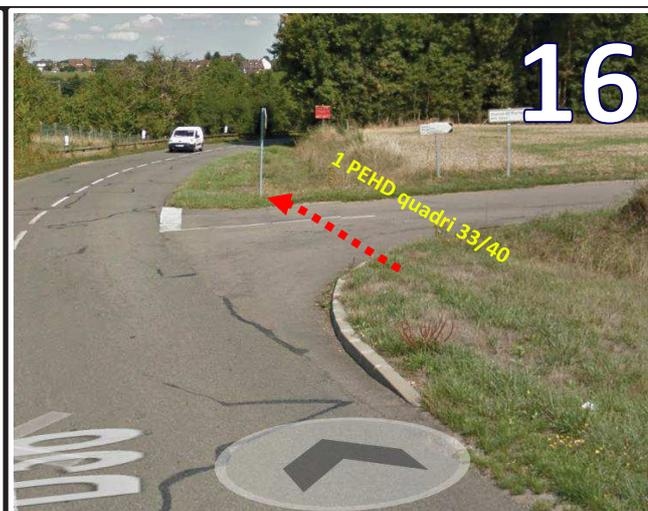
Pose de 1 PEHD quadri 33/40 non torsadé avec fil plynox en tranchée mécanisée (soc) en terrain naturel ou en accotement sur 60cm de profondeur
